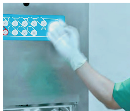
Sensor óptico en el panel.
